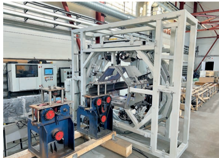
Установка измерения геометрических параметров и поверхностных дефектов рельса на рельсобалочном стане при температуре до 1100 градусов Цельсия
